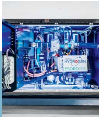
100kW Brennstoffzellensystem von SwissHydrogen und ESORO mit PowerCell Brennstoffzellenstack.
